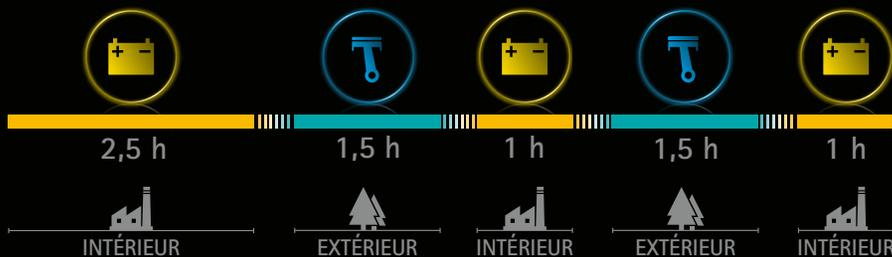
Grâce au système d'alimentation combinée Hybrid, la FSR peut être utilisée aussi bien à l'intérieur qu'à l'extérieur. Cette solution permet de choisir l'alimentation à essence pour les espaces extérieurs ou le silence et l'absence d'émissions du moteur électrique dans les espaces intérieurs.
