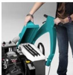
La poussière la plus fine est filtrée par un filtre à sac en polyester, avec un degré de filtration de 99,9% et une plus grande durée de vie par rapport aux filtres traditionnels. Le filtre peut être nettoyé avec un secoue-filtre mécanique efficace.
