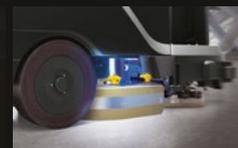
Le groupe de feux de service exclusif augmente la visibilité des parties pouvant être sujettes à des contrôles par l'opérateur, en éclairant les zones concernées avec des phares à LED
