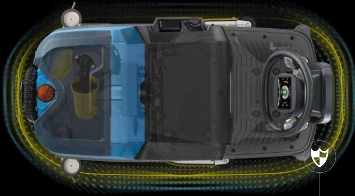
Sa structure en polyéthylène ne laisse aucune partie exposée et abrite tous les composants à l'intérieur.
