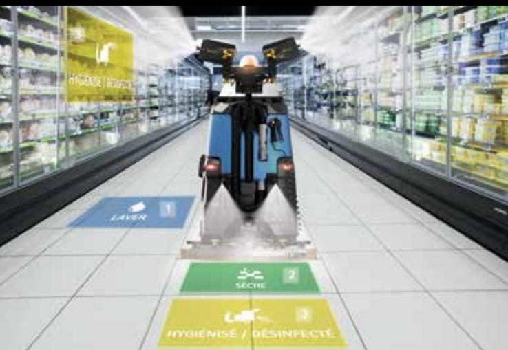
Pendant que BMg Disinfecteur effectue le nettoyage du sol, des groupes de buses positionnés au-dessus du réservoir et de la base de la machine pulvérisent le liquide désinfectant sur le sol qui vient d'être nettoyé et sur les murs et les mobiliers jusqu'à une distance et une hauteur de 3 mètres.
